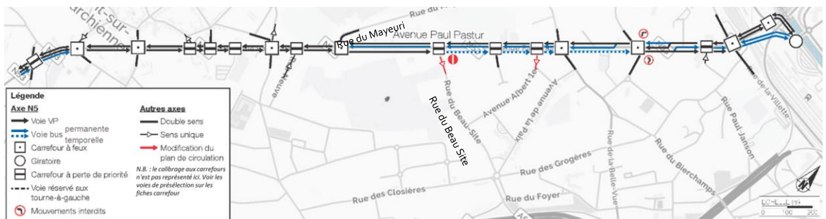
Figure 18 – Aménagements BHNS sur le secteur "Nord place" (N53)
